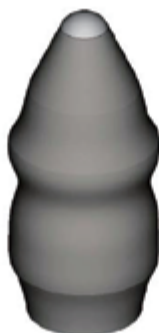
軸上から加振したときのODS (184Hz)
