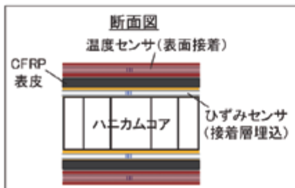
温度センサ (表面接着) ひずみセンサ (接着層埋込)
