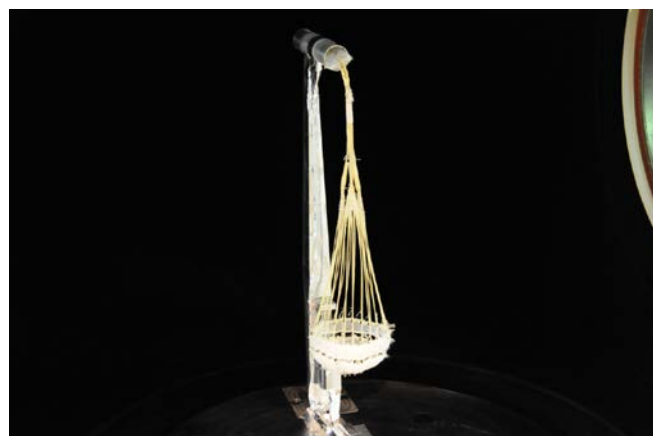
図 1 パラシュート風洞模型(S-2)
