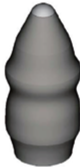
軸上から加振したときのODS (184Hz)
