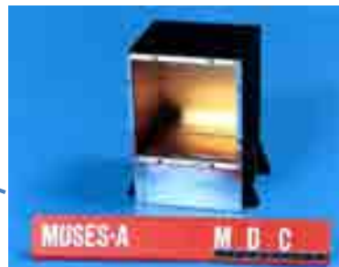
Munich Dust Counter (MDC) (故山越和雄教授提供) 開口面は約10cmx10m
