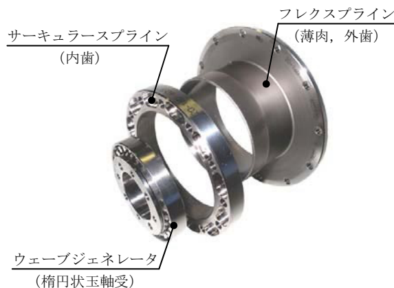
図 1 宇宙用波動歯車装置 2)
