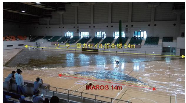
ソーラー電力セイル構造モデルと IKAROS セイルの展開試験 (ネット生中継も行った)
