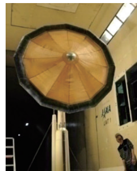
プロトタイプモデルの 耐空力荷重試験(低速風 洞試験)の様子
