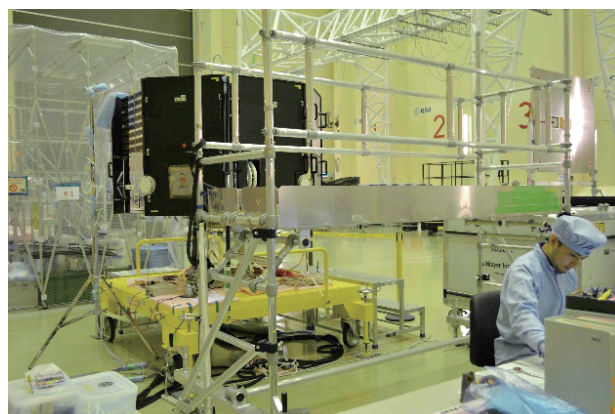
探査機（MMO）と電気試験実施の様子（ESA/ESTEC）
