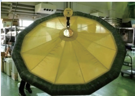
プロトタイプモデル (模型の主要なスペック) *外直径 2.5m *チューブ直径 15cm *総重量: 4.7kg *気室材料: ポリイミド (使用温度 500℃) (耐熱性能 ~ 120kW/m 2 )
