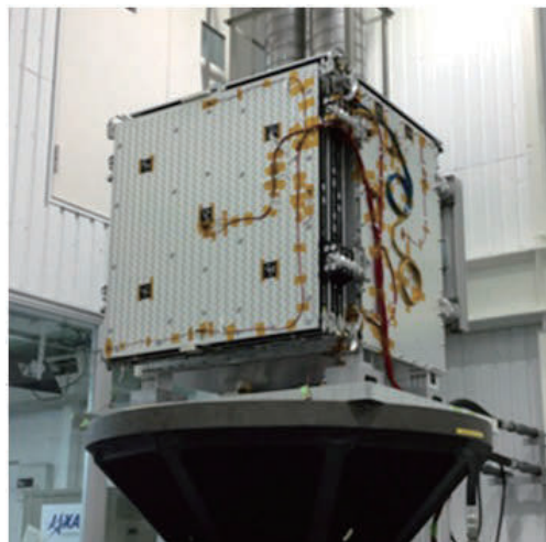
合成開口レーダアンテナと衛星構体の振動試験
