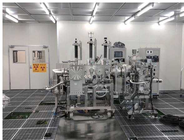
はやぶさ 2 帰還試料受入れ用新クリーンルーム内に設置が開始された新クリーンチャンバーの一部
