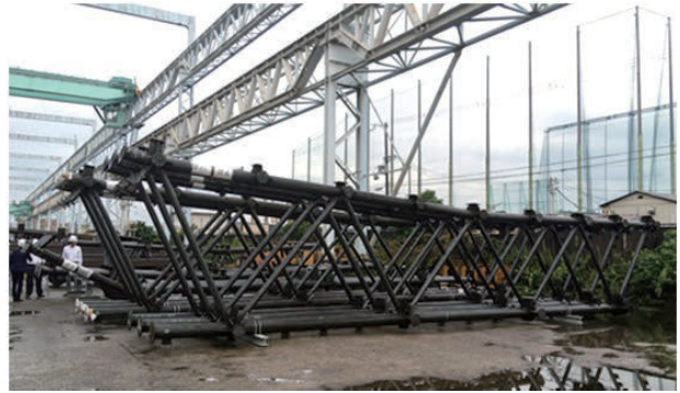
アンテナ主反射鏡のパネルを支える骨格（リブ）
