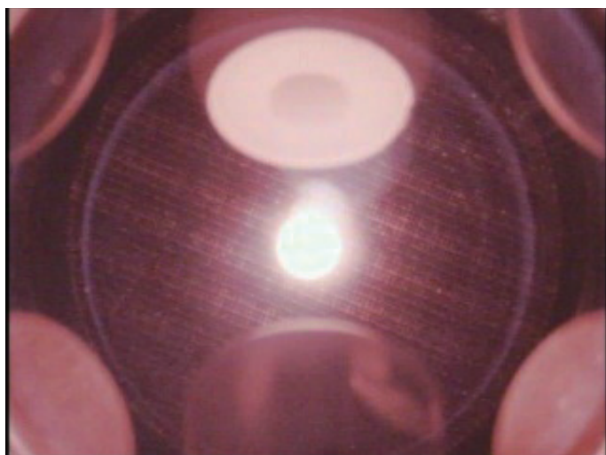
左上：ISS 静電浮遊炉内で浮遊する酸化エルビウム融体 (中央の白円部分)
