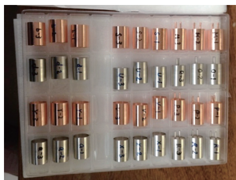
極低温対応ハーメチックコネクタの試験サンプル
