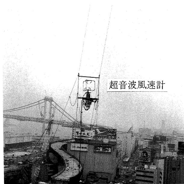
図2.3.1 3次元超音波風速計
