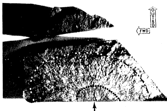
図 4-19 破壊の起点となったボア部の鍛造欠陥 (文献 (14) より)
