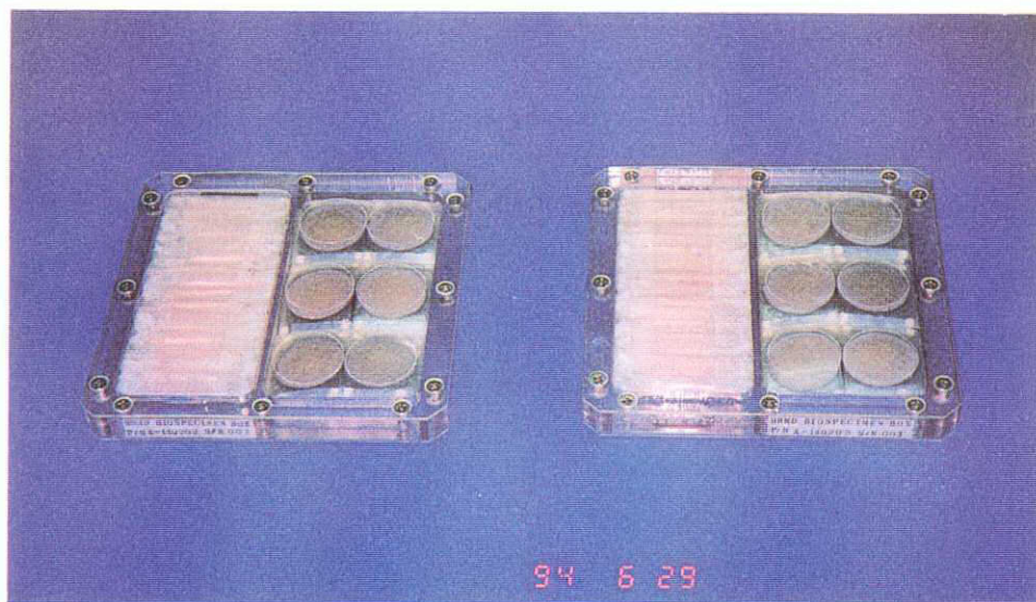
図 1 生物サンプルを装填したバイオスペシメン・ボックス (左：地上サンプル、右：宇宙サンプル)
