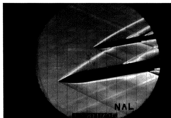
図 4 (5)b 2 台のアガード B 模型の配置と衝撃波のシュリーレン写真, \Delta x/l_1 = -0.068 , M_\infty = 2.51 , \Delta z/l_1 = 0.1946
