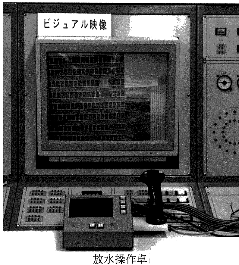
図 2.2 放水操作員用模擬視界と放水操作卓
