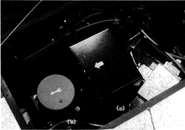
図5 模型搭載IMU (a) およびバーチャルジャイロ (b) の外観写真
