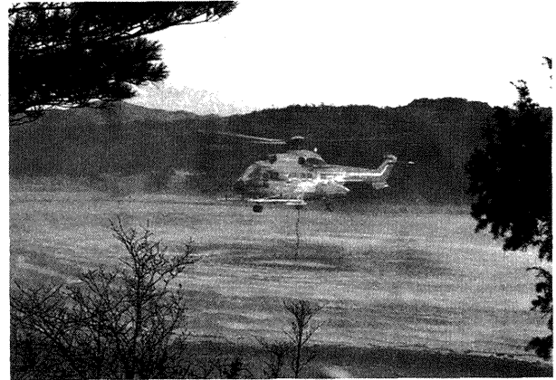
図13 飛行試験風景(自己給水模擬)
