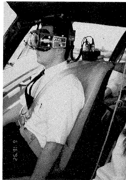
図3 ヘッドユニットのパイロットへの装着状況
