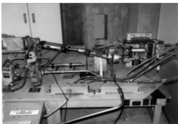
図2.b 3重系油圧操縦装置の外観
