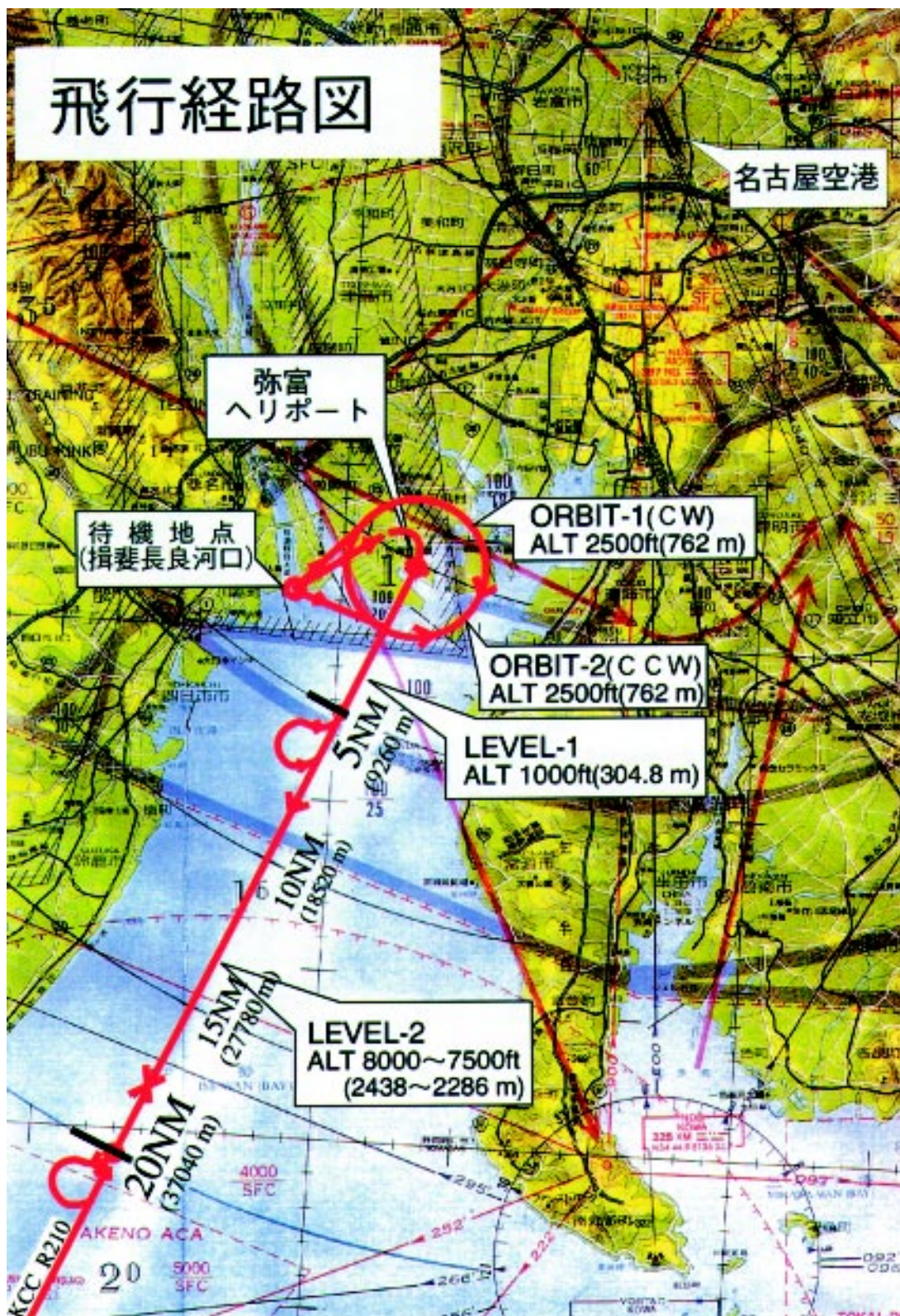
図16 実験計画飛行経路図
