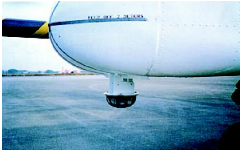
図13 機首下面に装備されたレーザ・リフレクタ
