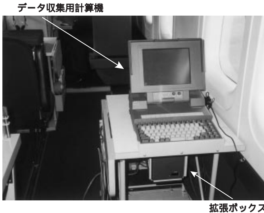
写真 3 データ収集用計算機の搭載状況
