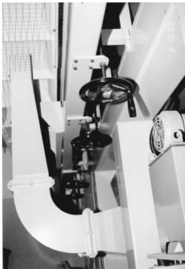
図8 後方フラップ変角用手動ハンドル
