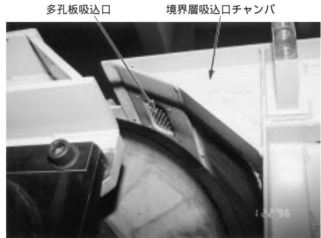
図 7 境界層吸込口チャンバと他孔板吸込口の外觀
