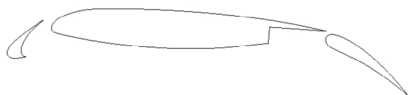
図13 30P30N高揚力装置の断面形状
