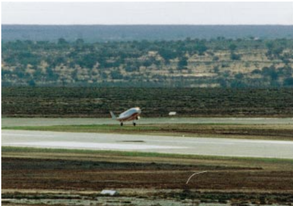
写真1 地上風計測高度6mをファイナルフレア中のALFLEX実験機
