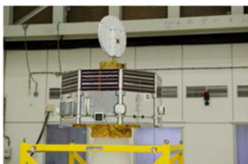
MMO 熱モデルTTM ソーラ試験を中心とした評価を実施するため、特に実機の外表面特性、形状に対し高い忠実度を有している
