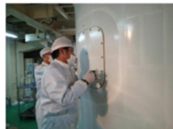
ドアクローズ作業 (口600ドア：打上げ当日)
