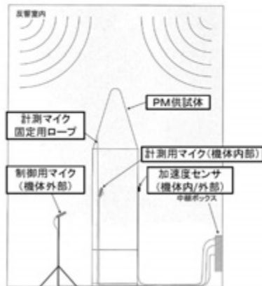
PM音響試験(左:試験方法概要 右:試験状況)
