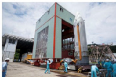
フェアリングVOS (1段モータへの搭載)
