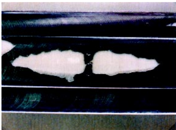
図 14 はく離領域の切削 ( \sigma_{max} = 147\text{MPa} )
