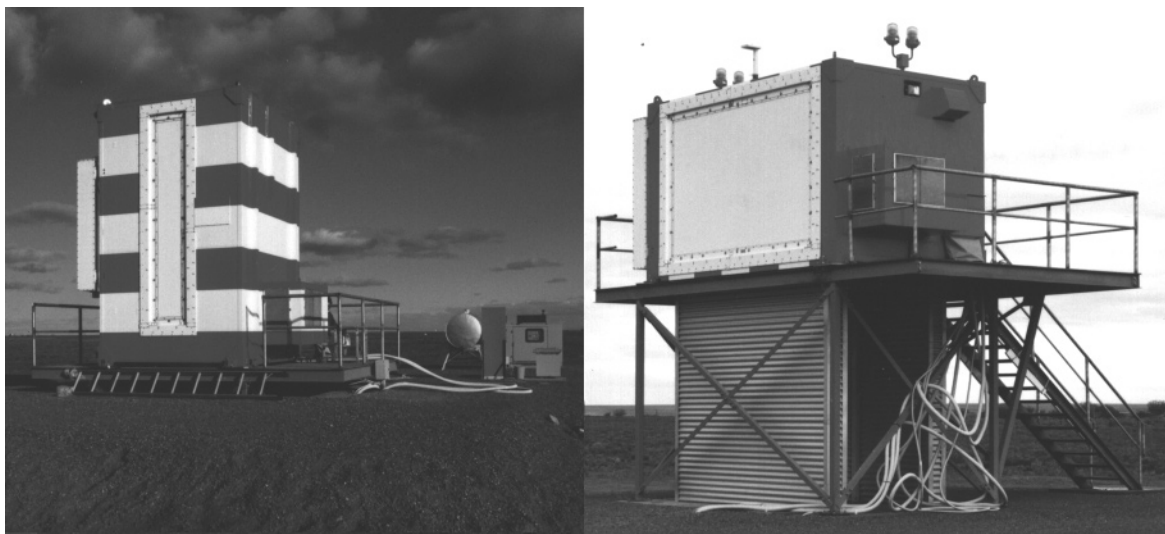
図 3.4.2-12 MLS 高低誘導装置と方位誘導装置（写真）
