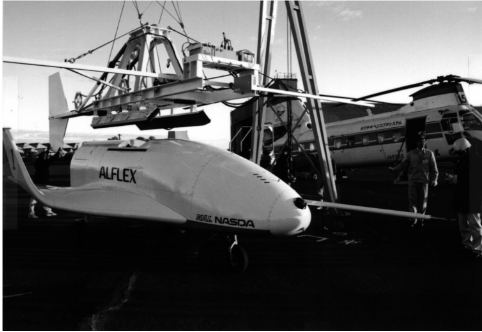
図 4.2.3-2 実験機と懸吊装置の組み合わせ作業（写真）
