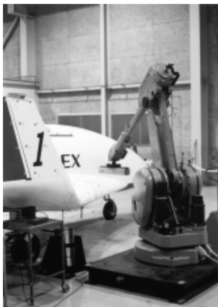
図2 - 3 ロボットによる振動計測状況
