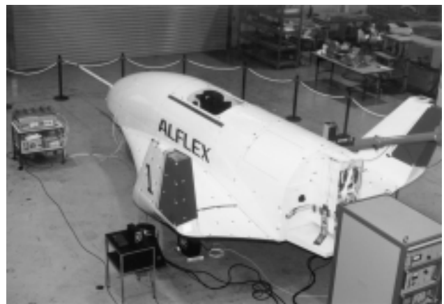
図 2 - 2 全機振動試験状況
