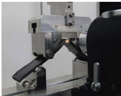
試験時はコーナー部を光学顕微鏡で観察
