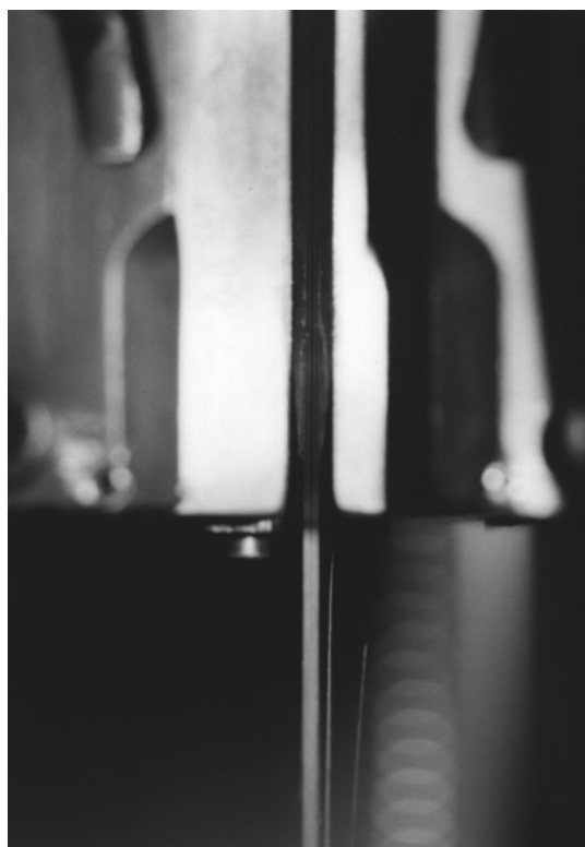
図10 タブ剥離部において接着剤が粉状になって溢れた様相
