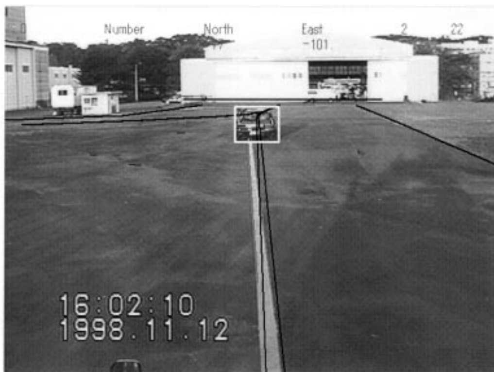
図 6. 6 ビジュアル結果の例 (白い矩形は障害物、黒い線は人工視界)
