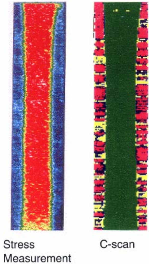
図 23 側辺から層間剥離を生ずる CFRP 試験片の赤外線応力測定結果と超音波探傷結果比較
