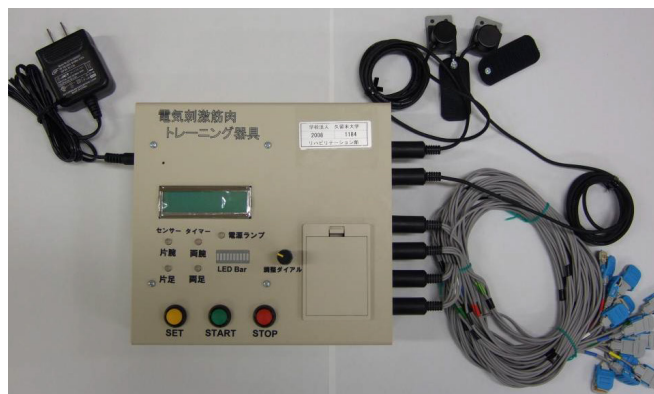
Fig.2 電気刺激装置と電線、電極クリップ、関節運動感知センサ
