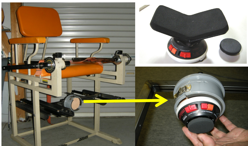
Fig.5 作製した筋力測定装置: イスの矢印の位置に市販のハンドヘルドダイナモメーター(HHD)を装着する。左図は膝屈曲用に設定。膝伸展では HHD は逆向きとなる。右上は被験者接触部分を大型化した新たに作製したパッド。
