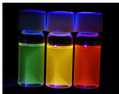
図 1: ZAIS 溶液の発光の様子 (左から x=0.4, 0.7, 0.9 )
