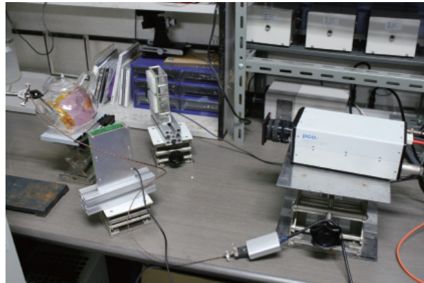
図 3: 実験装置. ポット内壁に貼りつけた PtOEP-PS センサホイルを緑色 LED で励起, センサホイルの燐光をカメラで記録する.
