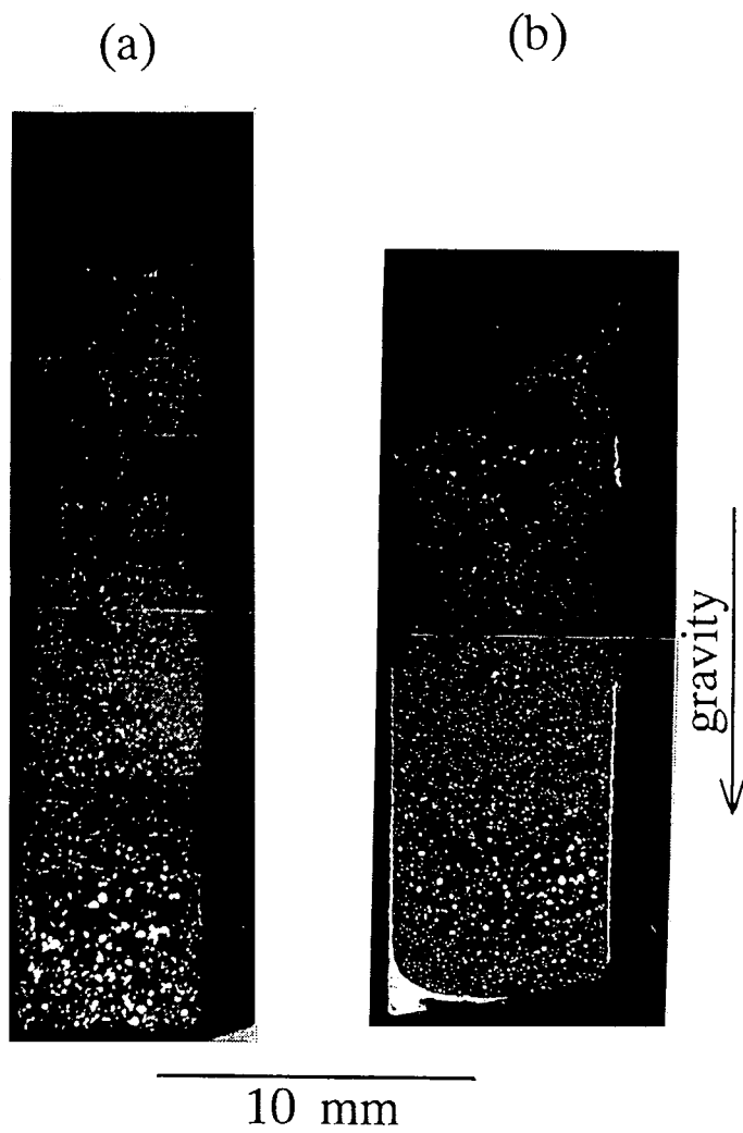
図7 研磨後の(a)CHF-13E, (b)CHF-15Eの断面の反射電子像
