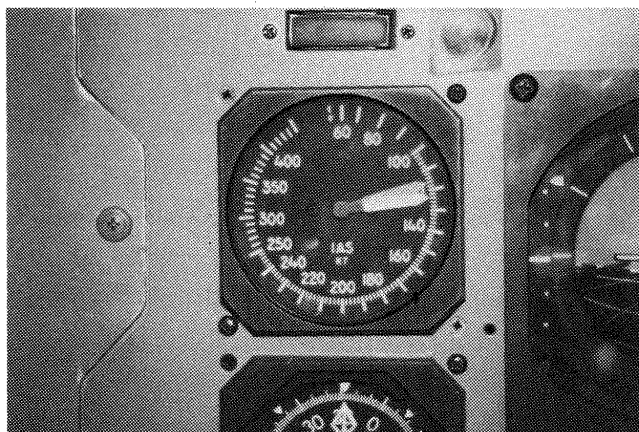
図 3.2 速度計の原形表示スケール
