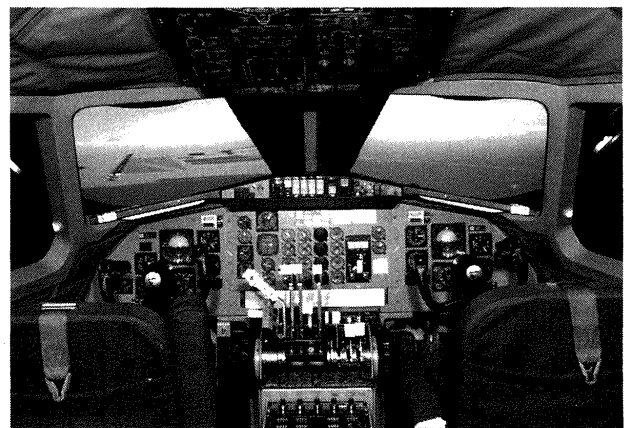
図4.3 航空宇宙技術研究所で所有する凹面鏡型無限遠方式の表示例 [f 16 15sec]
