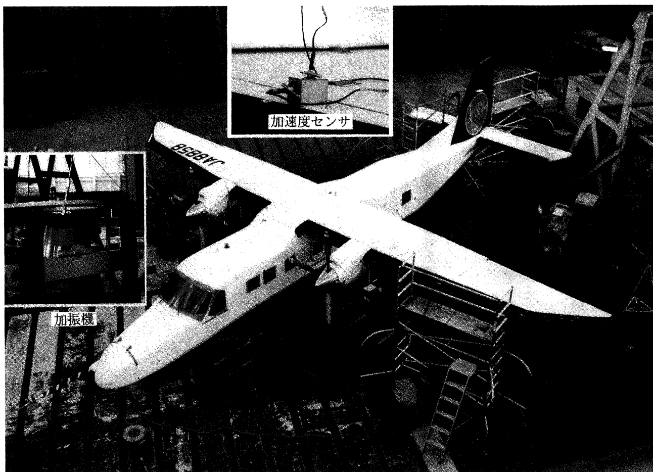
図2 地上振動試験中のドルニエ機
