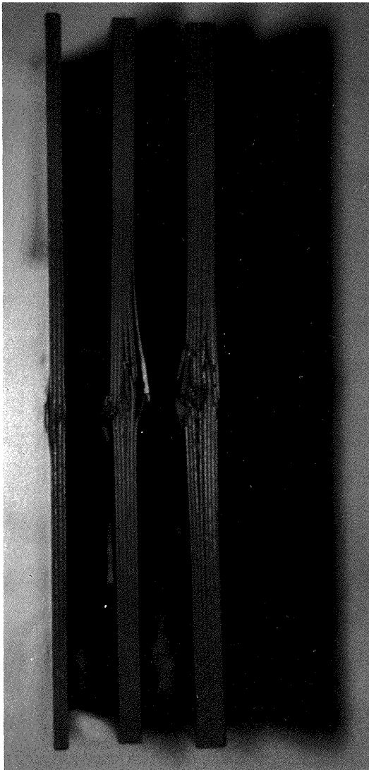
16 24 32 プライ 図20 側面の破壊状況（板の中央部での破壊）
