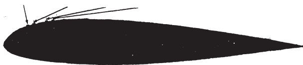
Fig.2 主翼断面形状および HF センサー貼付位置
