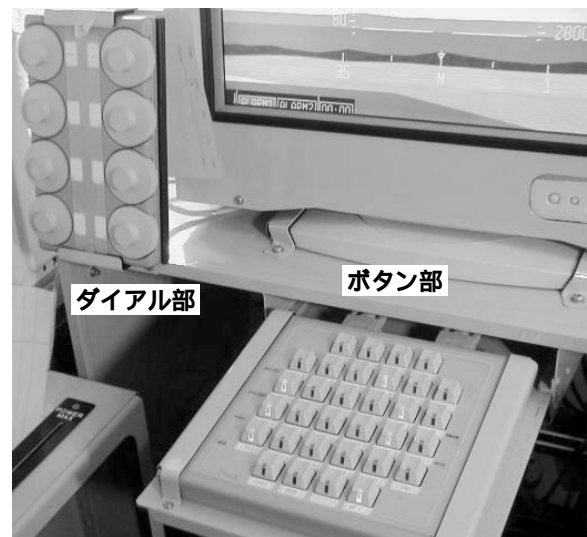
写真5-3-5 パイロット汎用スイッチ
