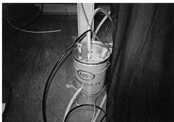
図 5.1.1 油煙供給の脈動を抑えるダンパー（20 リットル缶を使用）
