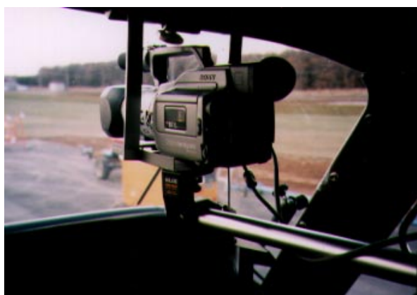
図8 コックピット内のカメラの設置
