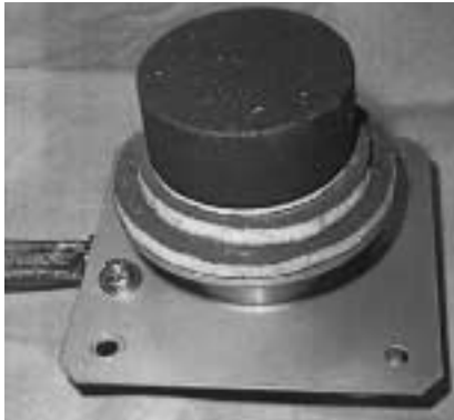
図2.8 セラミックタイル空力加熱センサ構造 (写真は熱モデル校正試験用センサ)
