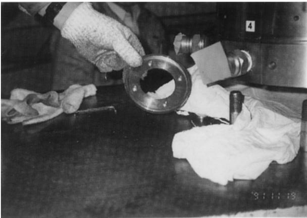
写真 A-4 継手本体、出力軸筒のストッパーの取り外し
