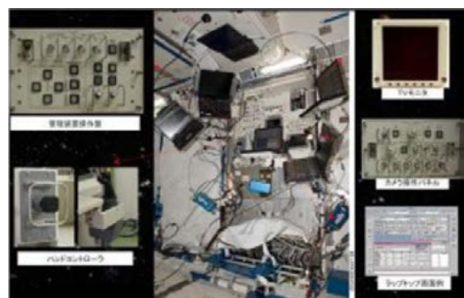
第 6 図 軌道上でのロボットアーム操作卓
