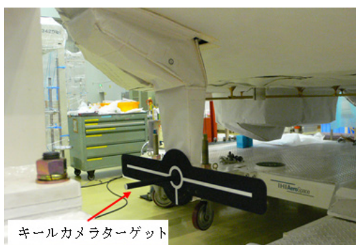
第 6 図 キールカメラターゲット取付
