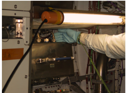
第 6 図 IVA 作業（操作する箇所に対し、容易に、障害なくアクセスできるかを確認する）
