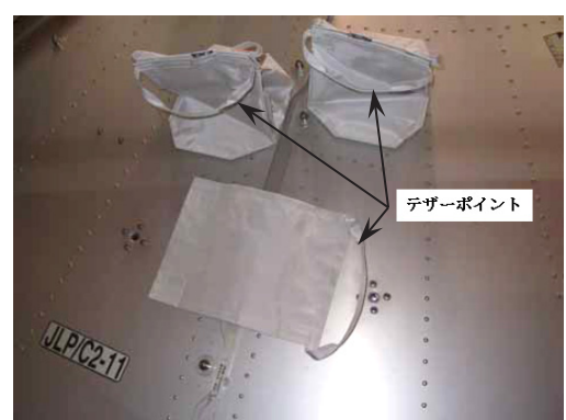
第5図 GPS アンテナ取付位置の 保護カバーとデザーポイント
