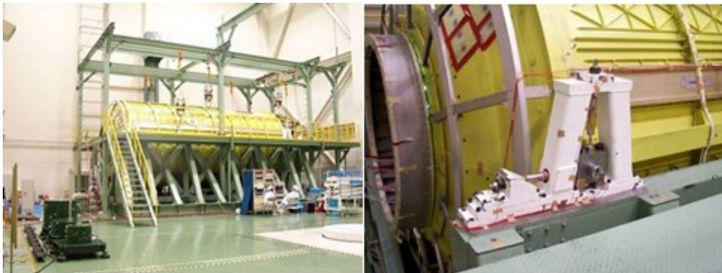
第 17 図 船内実験室のモーダルサーベイ試験
