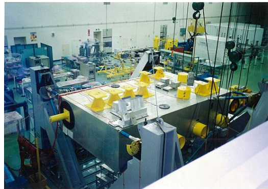
第6図 船外実験プラットフォーム モデル試験
