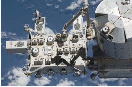
第 17 図 実験装置 3 体取付後の 船外実験プラットフォーム
