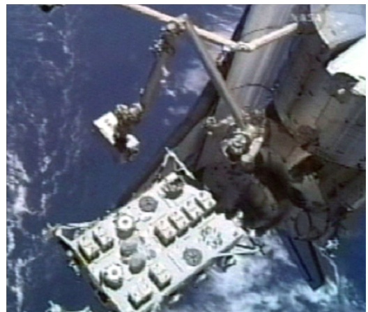
第 16 図 JEMRMS による最初の実験装置の取り付け
