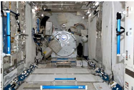
第9図 船内実験室の軌道上でのラック取付後状態
